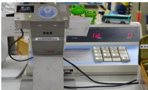
点呼用アルコールチェッカー
